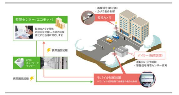
また、監視作業効率の向上、監視品質の均質化のため、AIによる融雪監視機構を開発しました。センサーを使った現地での降雪状況やカメラ画像のほか、1kmメッシュの気象予報情報を組み合わせて現地の積雪状況を推定し、適切な融雪装置の制御判断材料を提供しています。さらに、オペレータの操作をAIへフィードバックし、学習させることで、AI判断精度の向上を図っております。
